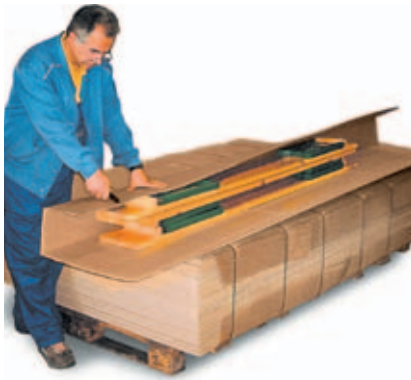
Mit dem Packmesser die Stirnseiten einschneiden, einklappen und fertig ist die Versandverpackung – in praktisch unbegrenzter Länge.
